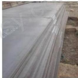
B级：已发生锈蚀，并且部分氧化皮已经剥落的钢材表面
